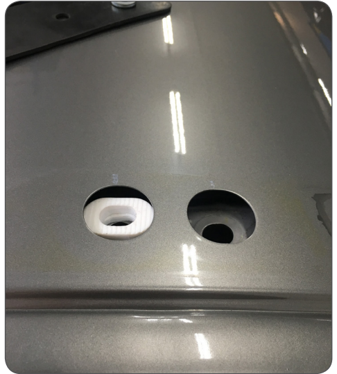
Abb. 2: Montage Löcher mit vorne, inkl. einem eingesetztem Distanzstück / mounting holes front with one placed spacer
