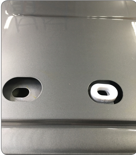
Abb. 1: Montage Löcher mit hinten, inkl. einem eingesetztem Distanzstück / mounting holes rear with one placed spacer
